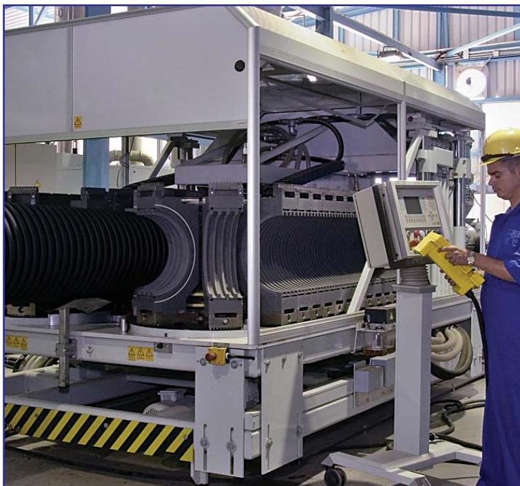
Producción de tubería corrugada de PEAD para alcantarillado.
